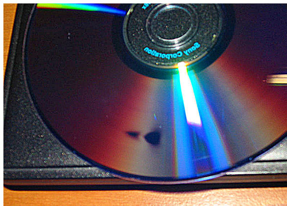
Figuur 2: Een schijf met zichtbare ‘disc rot’ of verrotting van de schijf (donkere vlekken)
