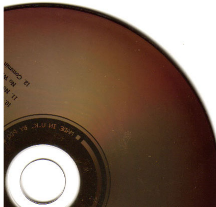
Figuur 3: verbronzing (cd-da) – een variatie op verkleuring
